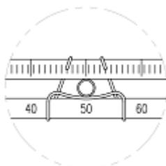
＜繋ぎ棒をフィードバック・レバーとレバー・スプリングの間に正しく挿入した例＞
